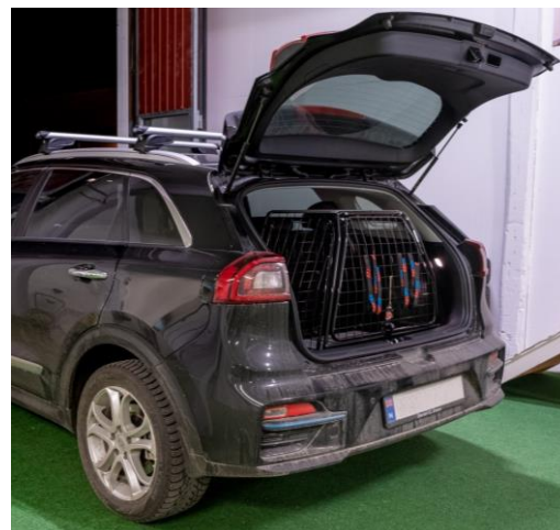
Medium gavel i en Kia E-Niro bil med lastrumsgolv i låg nivå buren är uppbyggd ca 5cm under för att dörren ska kunna löpa fritt över bilens tröskelkant
