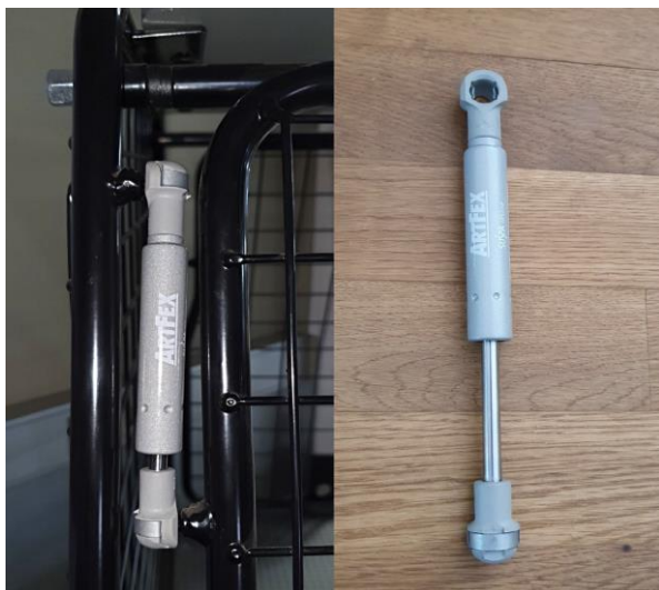
Bilden till vänster uppvisar korrekt monterad gasdämpare Bilden till höger uppvisar en omonterad gasdämpare
